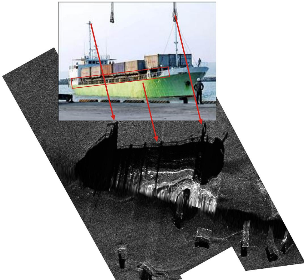
圖 5.5：德興輪聲納陰影說明 1，顯示船首及船尾的桅杆仍舊矗立，船舷欄杆由高頻率的側掃聲納掃瞄下一覽無遺。
